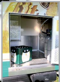
Kühlraum mit Fass- anschluss
